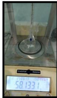
(Piknometer yang berisi sampel ditimbang)
