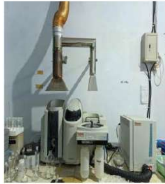
4. Pembacaan Sampel di alat Spektrofotometer Serapan Atom (SSA)
