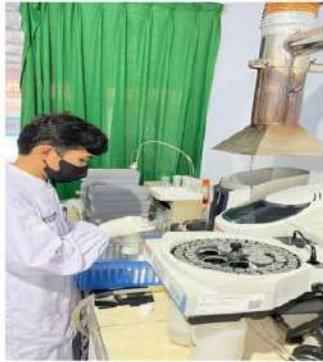
4. Pembacaan Sampel di alat Spektrofotometer Serapan Atom (SSA)
