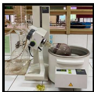
Proses pemisahan pelarut dan sampel menggunakan alat rotary evaporator
