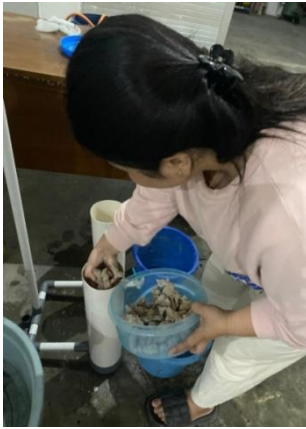
Proses memasukkan Batu Apung Ke Media filter
