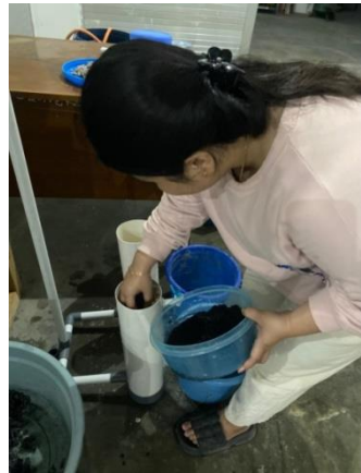
Proses memasukkan Karbon Aktif Ke Media filter
