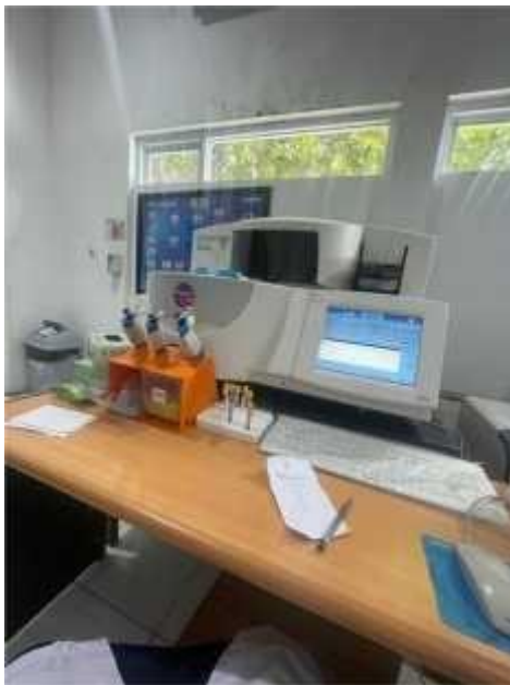
Gambar 2. Pemeriksaan LDL Kolestrol menggunakan Alat ABX Pentra C400
